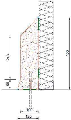
En option, ancrages de Ø10 - 150 mm ou 200 mm avec le bi-composants Polysto Chemfix.
